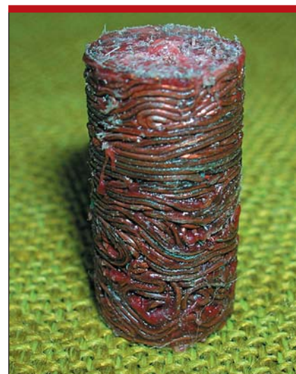
Рис. 6. Медный цилиндр с содержанием металла 98 % (масс.) после отжима полимера
